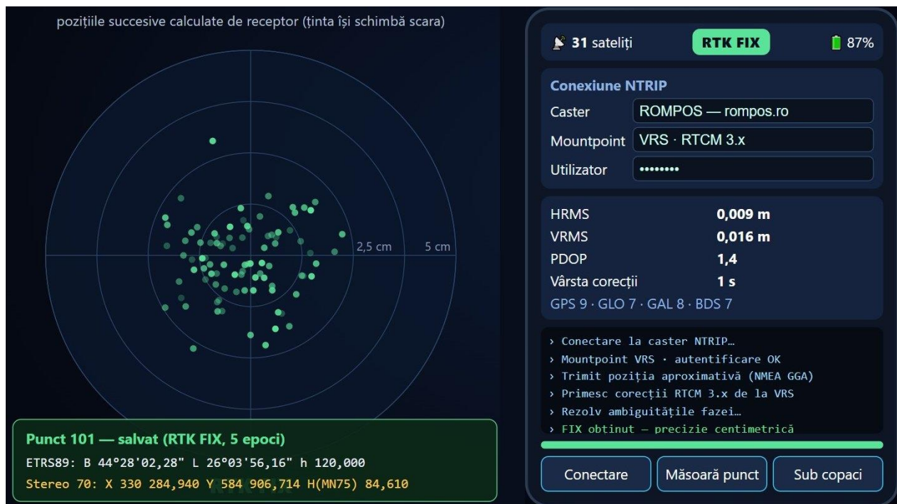
Figura 3.5. Controlerul RTK: pozițiile succesive calculate de receptor se strâng într-un cerc de 1–2 cm (stânga); conexiunea NTRIP la ROMPOS, starea RTK FIX și indicatorii de calitate HRMS 0,009 m, VRMS 0,016 m, PDOP 1,4 (dreapta).
