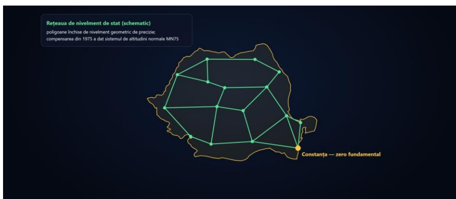
Figura 1.14. Rețeaua de nivelment de stat (schematic): poligoane închise de nivelment de precizie, legate de zero fundamental de la Constanța.
