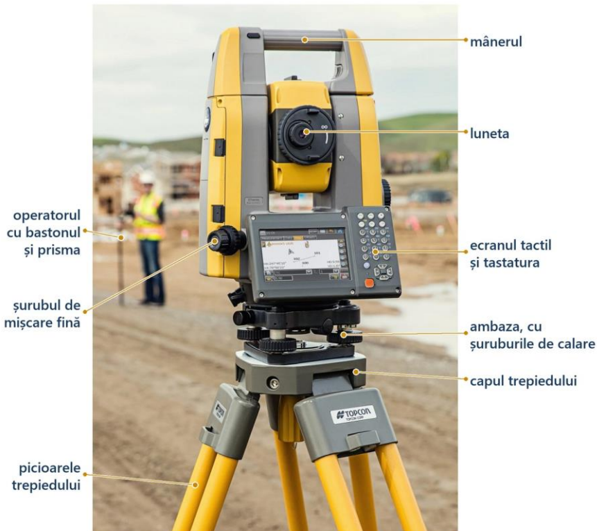
Figura 2.5. Stația totală instalată pe șantier; în planul al doilea, operatorul cu bastonul și prisma.
