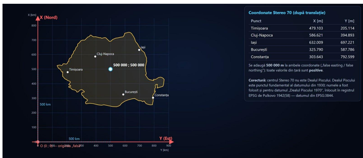
Figura 1.11. Translația originii cu 500 km spre vest și spre sud: centrul proiecției devine (500 000; 500 000), iar toate coordonatele din țară devin pozitive.
