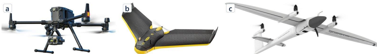
Figura 4.1. Tipuri de UAV folosite în topografie: (a) multirotor cu senzor pe gimbal; (b) aripă fixă; (c) VTOL.
