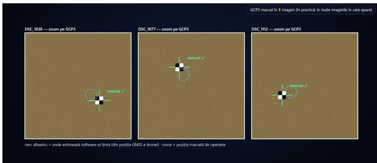
Figura 4.12. Marcarea punctului de control GCP3 în trei fotografii: cercul albastru — poziția estimată de software, crucea — poziția marcată de operator.
