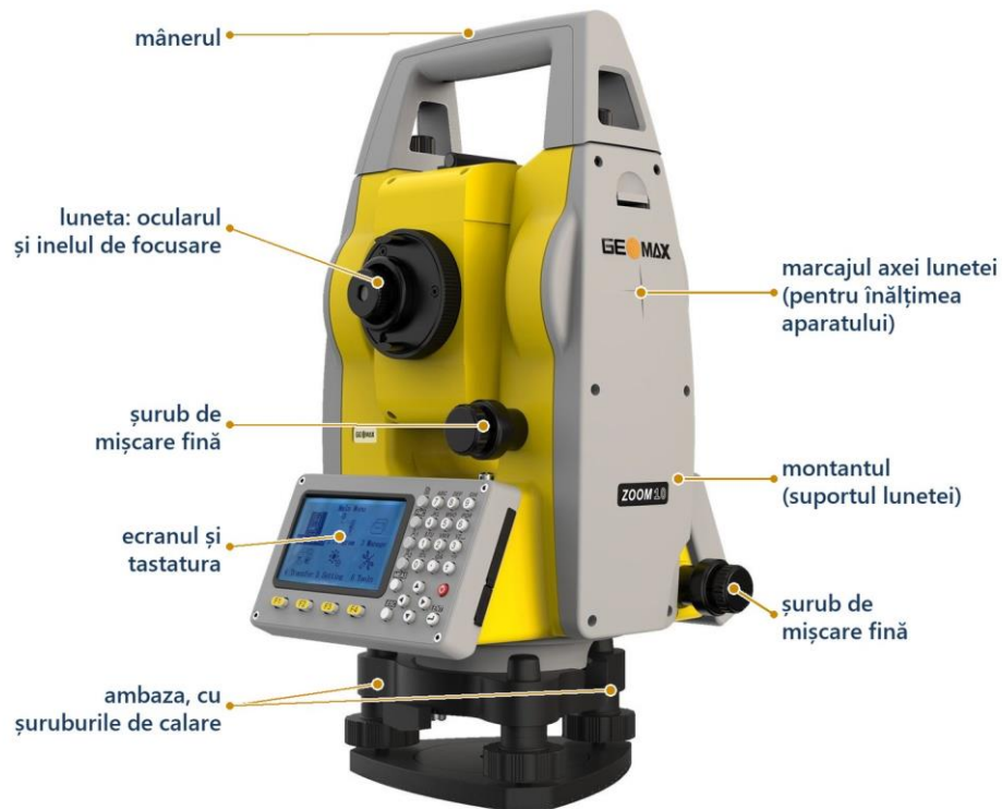
Figura 2.1. Componentele vizibile ale unei stații totale (GeoMax Zoom10).
