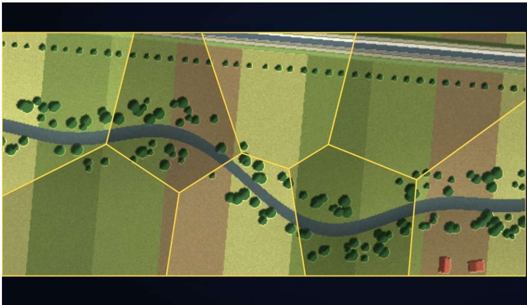
Figura 4.21. Mozaicarea: fotografiile ortorectificate, decupate pe liniile de îmbinare (galben), formează ortofotoplanul.
