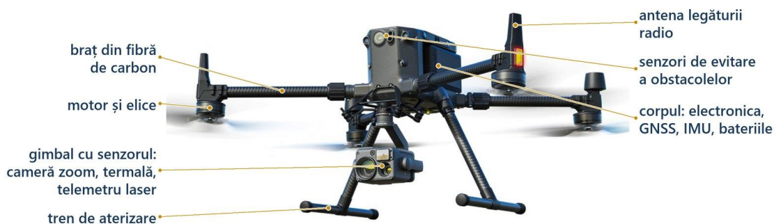
Figura 4.2. Componentele unei drone multirotor profesionale (DJI Matrice 300 RTK).
