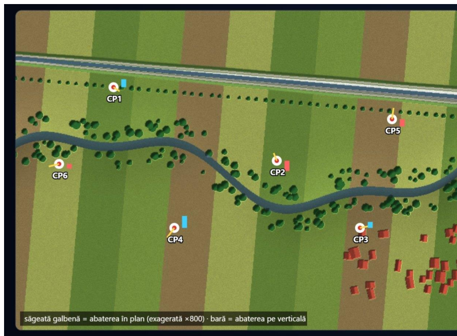
Figura 4.23. Punctele de verificare pe ortofotoplan, cu abaterile în plan (săgeți, exagrate de 800 de ori) și pe verticală (bare).
